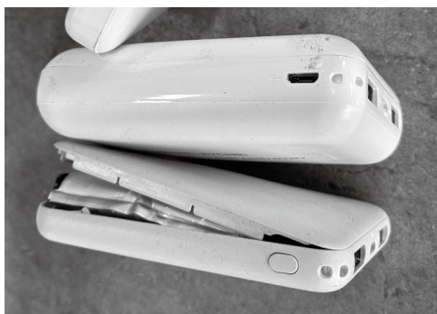
膨張・破損したモバイルバッテリー (上) (下)
